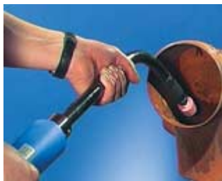
Schleifen in einer Bohrung
